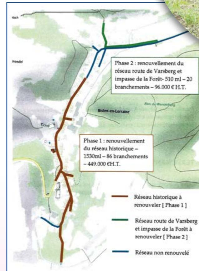
Plan complet des travaux de renouvellement du réseau avec les 2 phases.
